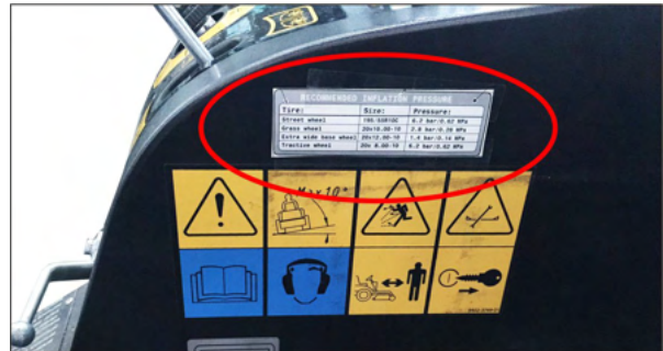
Slika: Naljepnica u kabini vozača s preporučenim tlakovima punjenja guma
