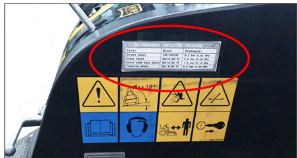
Slika: Nalepka v voznikovi kabini s priporočenimi tlaki v pnevmatikah
