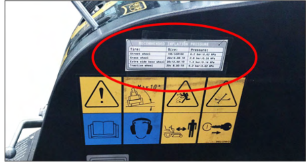
Фигура: Стикер с препоръчвани пълни налягания на гуми, поставен в кабината на водача
