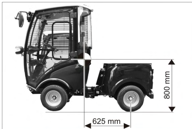
Poloha ťažiska bez integrovaných montážnych prístrojov.
