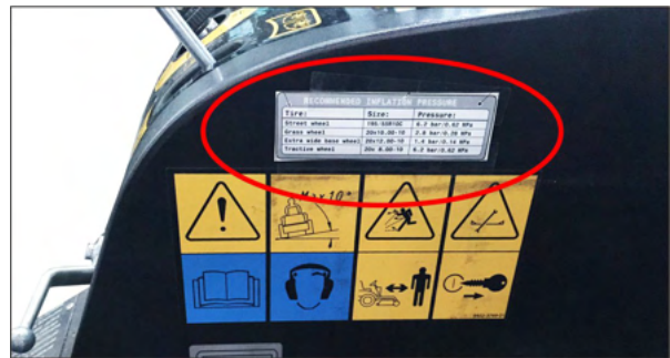
Ilustrace: Nálepka v kabině řidiče s doporučeným tlakem huštění pneumatik
