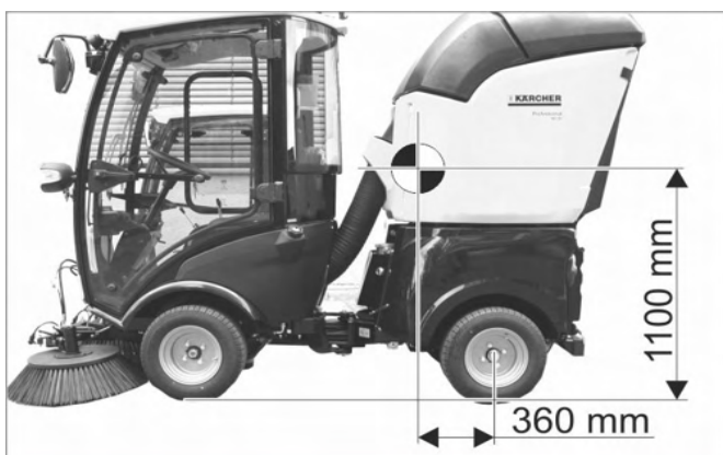
Poloha ťažiska pri plne naloženom prístroji.
