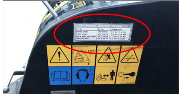
Obrázok: Nálepka v kabíne vodiča s odporúčaným tlakom v pneumatikách
