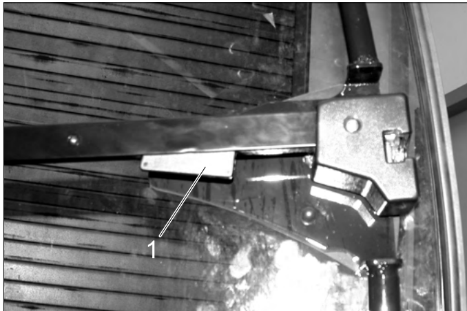
1 Sistem interior de deblocare ușă
