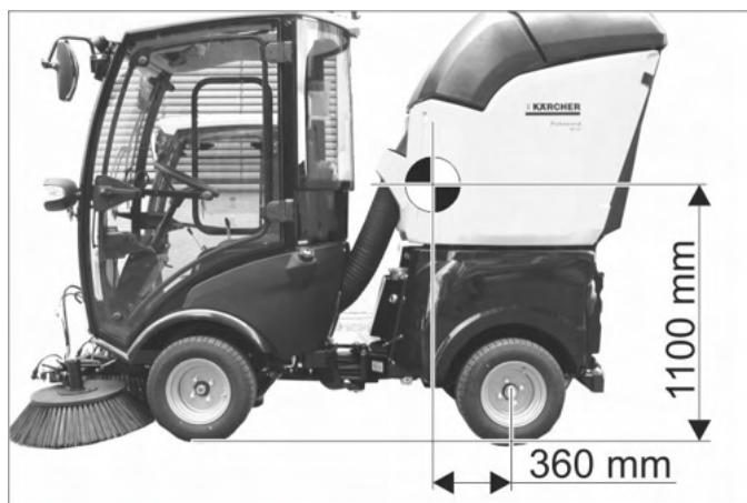
Položaj težišča pri polno napolnjeni napravi.
