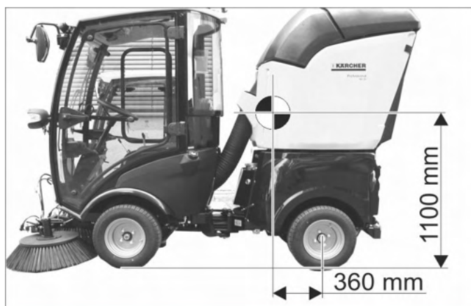
Těžiště při plně naloženém přístroji.
