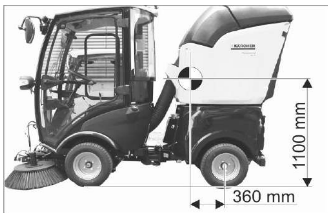
Těžiště při plně naloženém přístroji.
