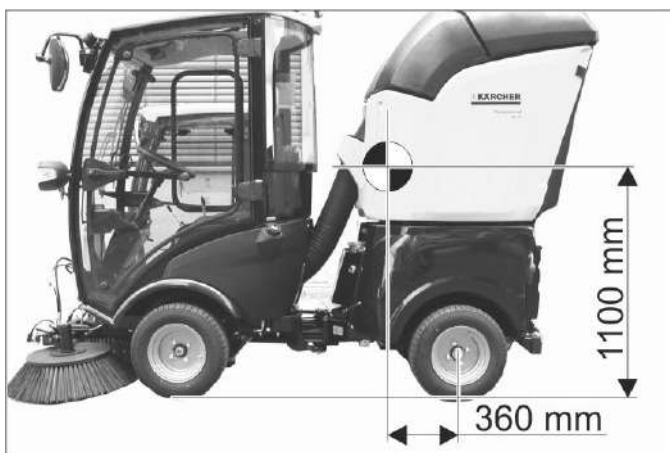
Položaj težišča pri polno napolnjeni napravi.
