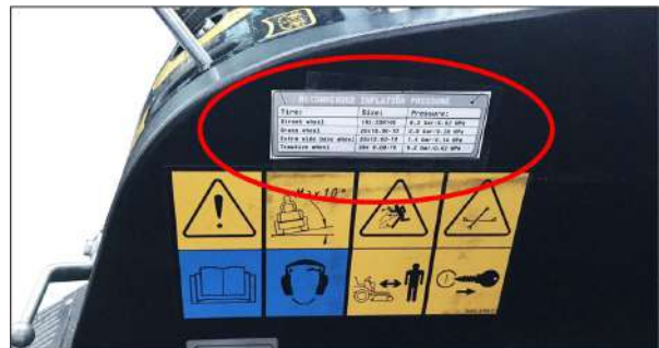
Ábra: Címke a vezetőfülkében a keréknyomás ajánlott értékeivel
