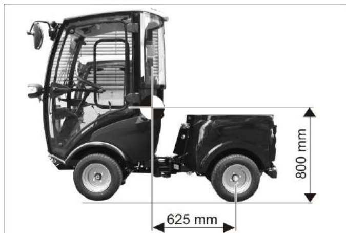
Poziția centrului de greutate fără accesorii montate.
