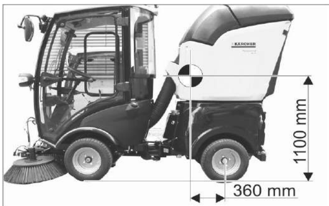
Poloha ťažiska pri plne naloženom prístroji.
